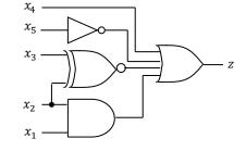
$$\bar{z} = \overline{x_1} \, \overline{x_2} x_3 \overline{x_4} x_5 + \overline{x_1} x_2 \overline{x_3} \, \overline{x_4} x_5 + x_1 \overline{x_2} x_3 \overline{x_4} x_5 = \overline{x_4} x_5 (\overline{x_1} \, \overline{x_2} x_3 + \overline{x_1} x_2 \overline{x_3} + x_1 \overline{x_2} x_3)
